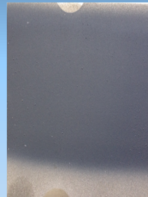
Provino rivestito, 60 micron di polvere.
